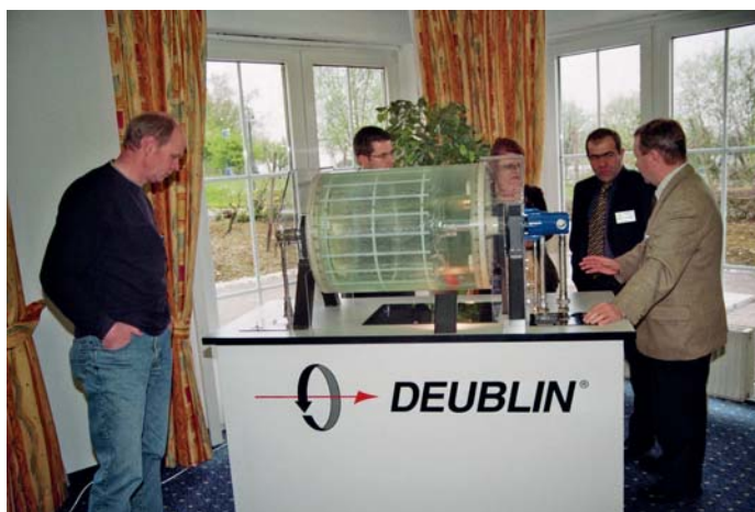
Modell eines Trockenzyllinders zum Studium der Entwässerung mit stehendem Siphon
